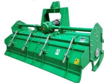
Hnífatætarei 230cm Öflugur tætarei fyrir traktora cat.2 70hp+ RPM 540 mesta vinnsludýpt 16cm, 60 hnífar. Einnig til 200cm.
