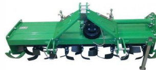
Hnífatætarei 180cm fyrir þritengið, cat.1, 350kg, fyrir 40hp+, RPM 540, mesta dýpt 15cm, 48 hnífar. Einnig 105, 125 og 150cm
