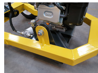
Motor i trapezophæng – betyder at motoren altid er i vandret position.
