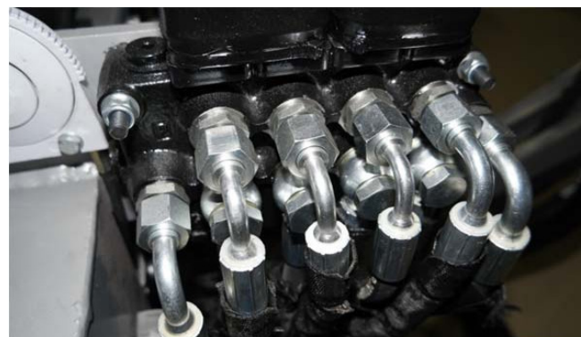
Fig. 54 Styreblok på højre side set i køreretningen
