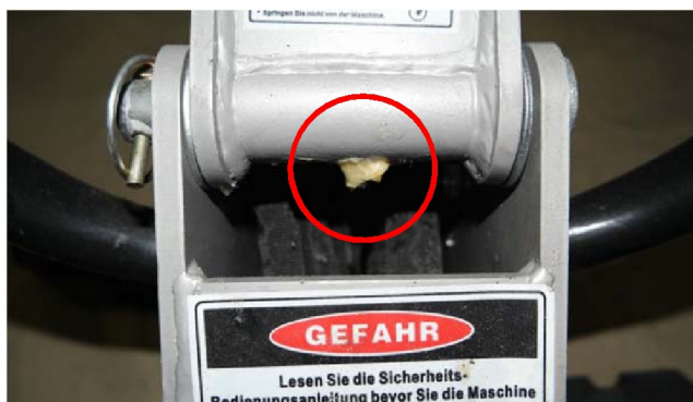
Fig. 17 Smøring af bolt nederst på hovedbommen
