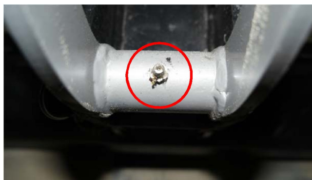
Fig. 21 Smøring af bolt på skovlkobling 2
