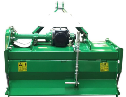
Justerbar bagskærm hvor man via fjeder, kan bestemme bagpladens tryk (planering)
