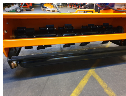
Hammerslagler der slår græsset
