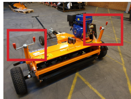
Højdejustering af baghjul / og højre/venstre montering
